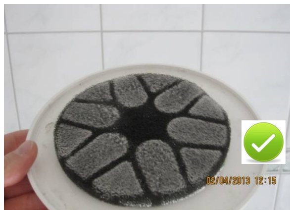
Abbildung 33: Flusenfilter bei Abluftdurchlass
