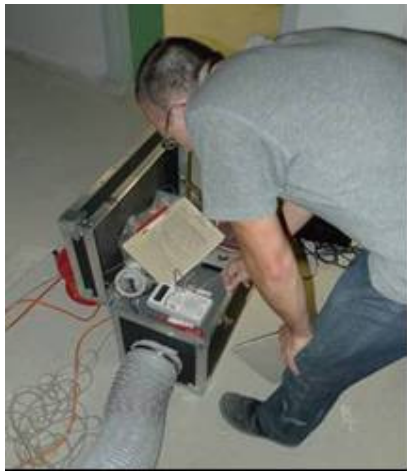
Abbildung 20: stichprobenartige Leckagemessung einzelner Luftleitungsabschnitten
