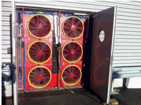
Abb. 14 Ventilatoren für einen Luftdichtigkeitstest (Blower Door Messung). Quelle: Ian Jack
